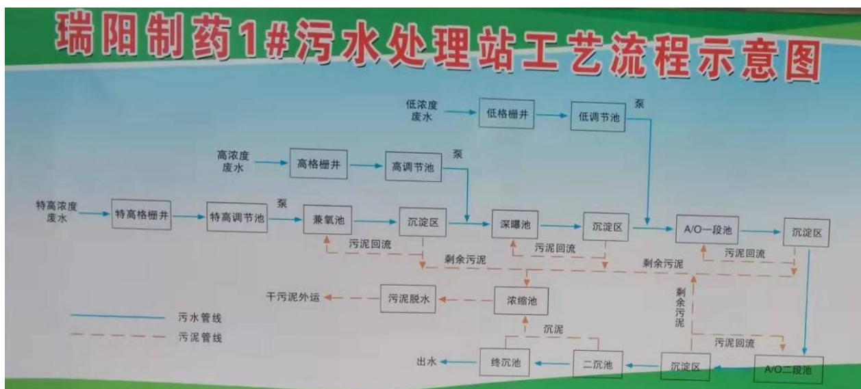
图 7 污水处理工艺流程图
